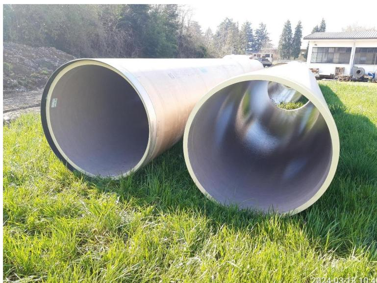
**Figura 5. Tubazione in PRFV utilizzata nel tratto fognario con posa NO-DIG.**
