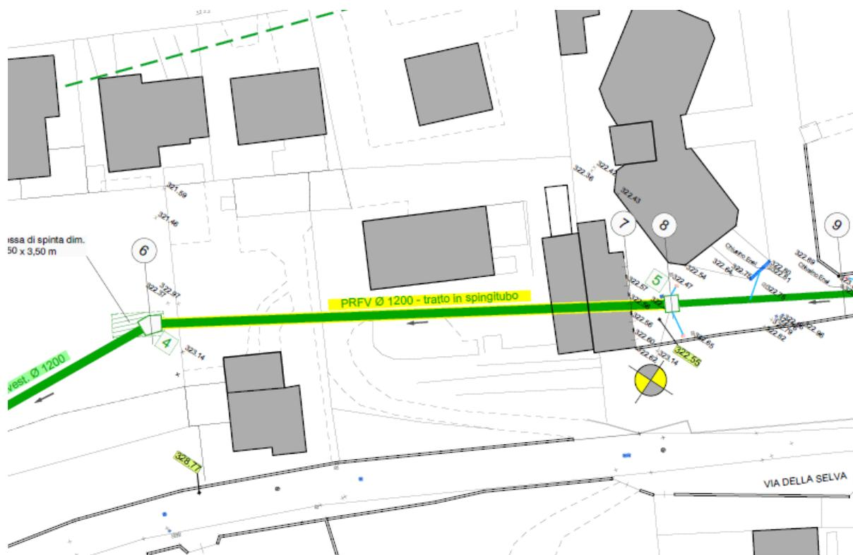
**Figura 2. Estratto della planimetria di progetto con il tracciato del collettore nel tratto in spingitubo**
